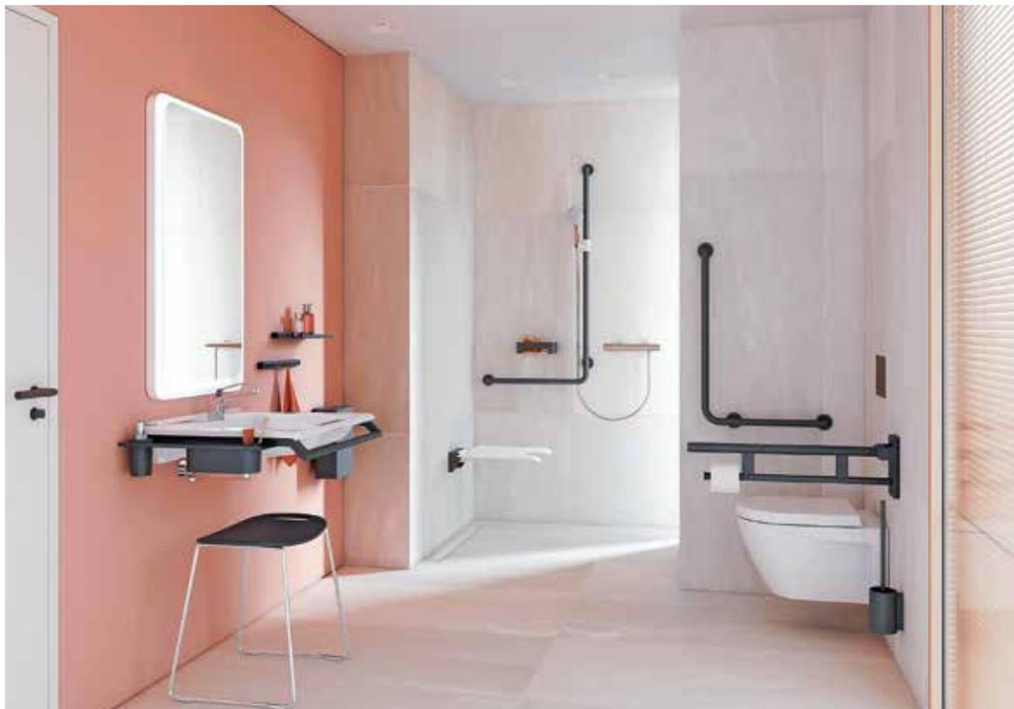
*Die Relingsysteme und Duschhandläufe von System 900 überzeugen durch eine clevere, besonders einfache Montagetechnik. Statt der üblichen vier Befestigungspunkte werden nur drei Rosetten benötigt. Dies beschleunigt die Montage deutlich. Zudem ist mit der neuen Befestigungstechnik ein Ausgleich der Winkeltoleranz in der Raumecke von bis zu +/-2° möglich.*
